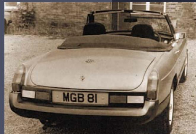
L'Aston Martin MGB possède un équipement spécifique qui inclut : sièges sport et capote Tickford, volant Australi 13" quatre branches, pare-brise et vitres latérales de la GT, moulures latérales noires, pare-choc avant modifié et spoiler, petite calandre chromée, feux arrière de brouillard et de recul, jantes en alliage de 14" Wolfrace.
