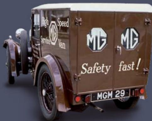
C'est un poids plume - 500kg - motorisé par un 4 cylindres de 847cc possédant un arbre à cames en tête, d'origine Wolseley. Sa puissance initiale est de 20cv et passe à 27cv pour les derniers modèles. Une version suralimentée sera disponible sur commande, permettant d'atteindre la vitesse de 80 mph (130km/h).
