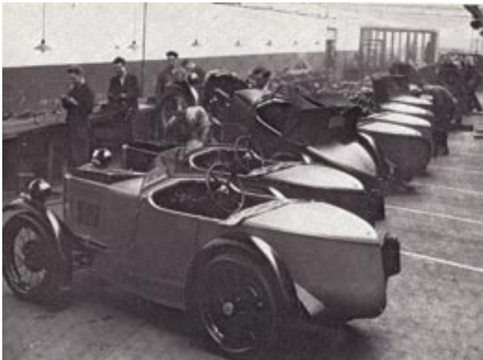
C'est une voiture minuscule puisque l'empattement est de moins de 2 mètres et le poids n'excède pas 500 kg grâce à une carrosserie faite de contreplaqué recouverte de simili. Son pare-brise à 2 pans de type bateau la rend jolie et harmonieuse.
