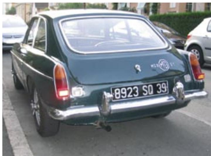
Ci-contre l'année 1970 voit l'apparition de phares de recul de pare-choc dont le butoir final est en caoutchouc, de roue à jante type Rostyle, les roues à rayons disparaissent définitivement. Le logo MG pour l'arrière est en aluminium moulé.
